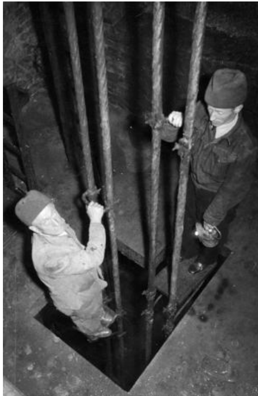
Abbildung 1.6: Vorführung auf der Fahrkunst bei der Eröffnung (Ludwig Müller und Otto Klöppelt von den Licht- und Kraftwerken Harz) Archiv: J. Klähn
